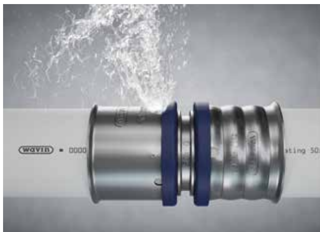
15. ábra: A LOKALIZÁLT SZIVÁRGÁS funkció a nyomáspróba során vízszivárgással mutatja meg az össze nem préselt csatlakozót.
