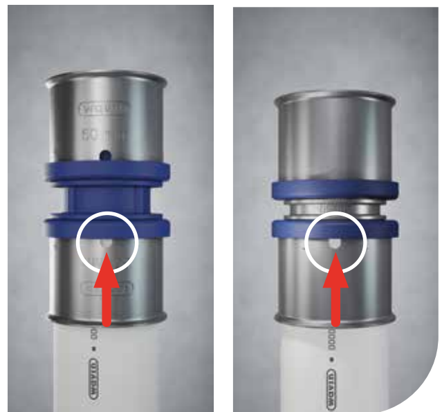
14. ábra: Az IN4SURE™ funkció segít ellenőrizni, hogy a csövet megfelelően helyezték-e be.
