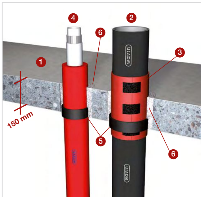
Bild 1: Gerade Rohrführung durch Decke.
