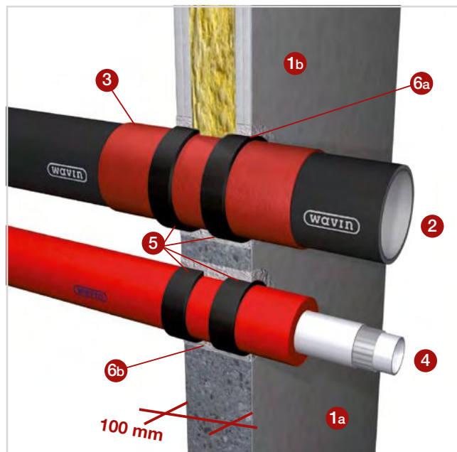
Bild 2: Gerade Rohrführung durch Wand.
