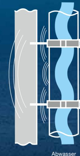
Von **Körperschall** spricht man, wenn sich Schall in festen Körpern durch Vibration ausbreitet. Bei Rohrinstallationen vor allem durch Rohrschellen und Halterungen in der Wand.
