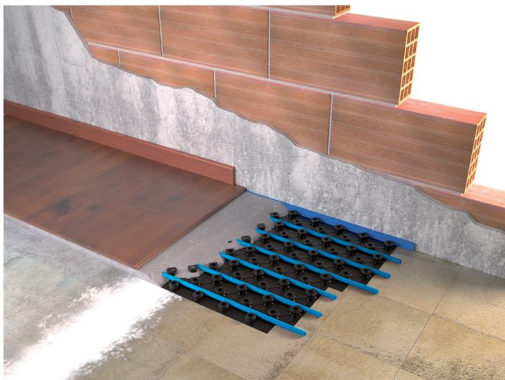
Il Sistema RENOVA incollato è pensato per la realizzazione di impianti radianti con massetto di basso spessore, quindi con bassa inerzia termica. Nato specificatamente per le ristrutturazioni, con applicazioni al di sopra del rivestimento di pavimenti esistenti, il suo utilizzo è andato estendendosi anche alle nuove abitazioni, in particolare nelle abitazioni a basso consumo energetico, proprio in virtù della sua bassa inerzia termica.
