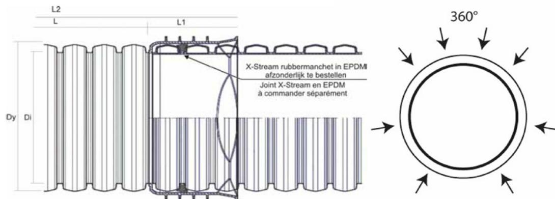
**Description:** Programme complet de tuyaux perforés lisses à l'intérieur et annelés à l'extérieur. Tuyaux avec manchon préformé. Le raccordement se réalise au moyen du joint X-Stream (à commander séparément). Les fentes de 1,5 mm sont réparties sur le périmètre du tuyaux (360°).
