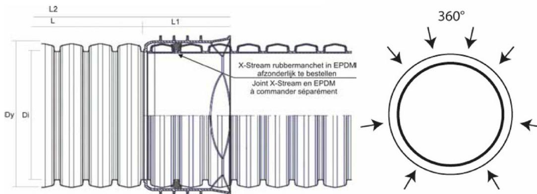
**Omschrijving:** Programma van gesleuvde buizen inwendig glad, uitwendig voorzien van ribben. Buizen met aangevormde mof. Verbindingen via de X-Stream rubbermanchet (afzonderlijk te bestellen). Sleuven van 1,5 mm op 360°
