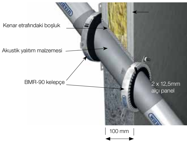
Şekil 25: Manşon/muf ile / manşon/muf olmadan 45° açılı montaj.
