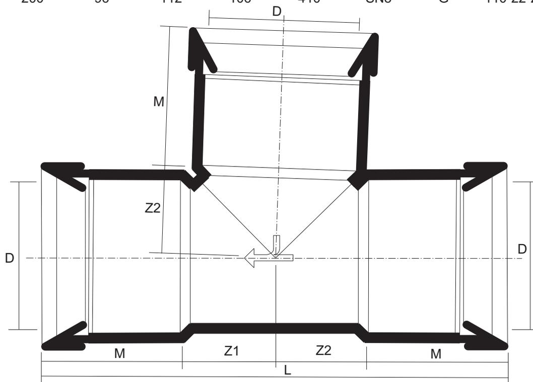
**Description:** Accessoires recyclables . Le sens d'écoulement est marqué de façon ineffaçable à l'extérieur de l'accessoire avec une flèche. Couleur: G = grise = RAL 7037; R = rouge brique = RAL 8023.
