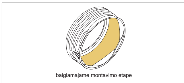
Guminio sandariklio ir vidinio įmovos paviršiaus sąlyčio vieta.
