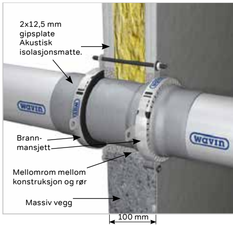
Rett gjennomføring med eller uten muffe.
