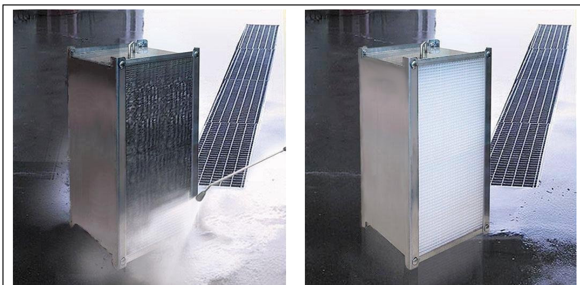
Fig 9. Rengöring av coalescensfilter med högtryckstvätt samt filter efter rengöring.
