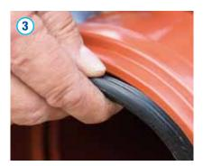
Si nécessaire, par exemple à des fins d'inspection ou de nettoyage, il est possible de retirer facilement le joint, puis de le remettre en place sans problème après le nettoyage. Conseil : lors de la mise en place du joint, il faut faire attention à ce qu'il soit bien orienté et à ce qu'il s'insère bien dans la cannelure du tuyau.
