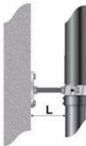
25. ábra: Ejtővezeték rögzítése merev szerkezethez
