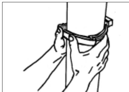
Klembøjlen sættes på med en enkel håndbevægelse. Skruer er unødvendige. En låsetapp i klembøjlen sikrer mod sidelæns bevægelse. Den specielle klembøjle til muffer kan være meget stram at montere. For at afhjælpe dette, bøjes klembøjlen gentagne gange i hænderne eller opvarmes forsigtigt på anden måde.
