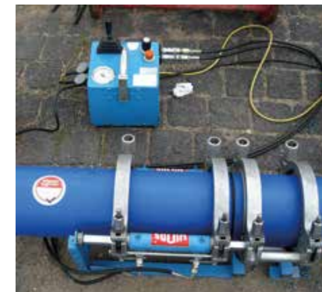
10. ábra: Tompahegesztő gép
