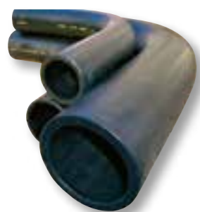
PE 100 ívek d 90 – 225 mm SDR 11 és SDR 17 11°, 22°, 30°, 45° és 90°, ívsugár 1,5 x d
