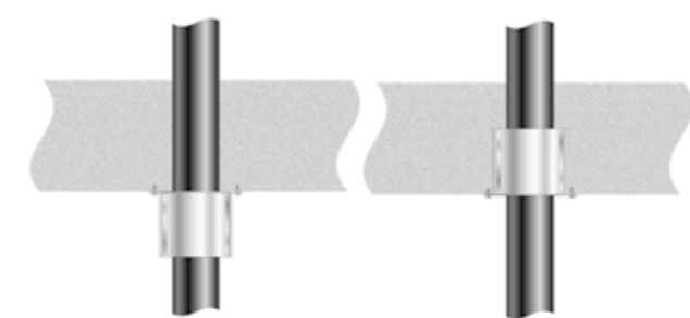
66 pav. Priešgaisrinių žiedų montavimas lubose.
