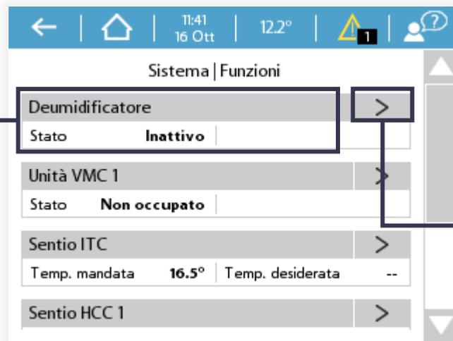
È possibile resettare il contaore del filtro aria del deumidificatore dal percorso *Sistema >> Deumidificatore >> Gestione filtri* e cliccando sull'apposita funzione 'Sostituire filtri'. Ricordarsi di sostituire i filtri nell'unità di trattamento aria
