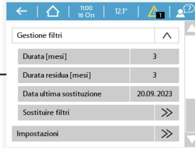
Menu utilizzato per impostare la durata del contaore filtri e resettare il promemoria quando si attiva nel menu allarmi. Ricordarsi di sostituire i filtri nell'unità di VMC
