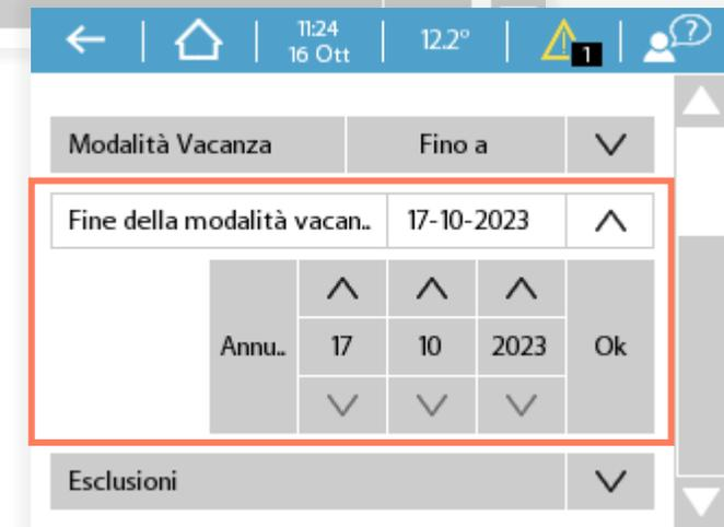
La *Modalità Vacanza* imposta l'unità con un setpoint di mantenimento minimo di 16°C in inverno e 40°C in estate. L'unità di VMC viene invece fatta lavorare alla velocità minima. È possibile attivare la modalità vacanza senza scadenza o fino ad una data preimpostata e inoltre si può scegliere se attivarla per tutte le zone o con alcune esclusioni
