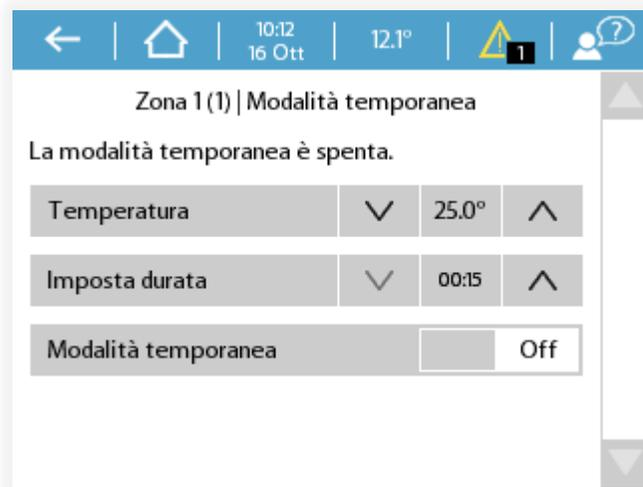
Da questo menu è possibile forzare il funzionamento dell'impianto sulla base di un setpoint 'temporaneo' e per un tempo impostato
