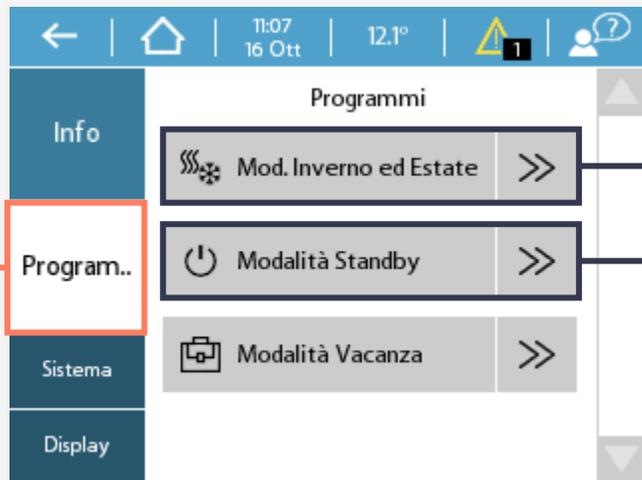
La *Modalità Standby* imposta l'unità con un setpoint di mantenimento minimo di 6°C in inverno e 40°C in estate. L'unità di VMC viene invece fatta lavorare alla velocità minima
