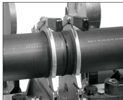
Chladnutí svařeného spoje
