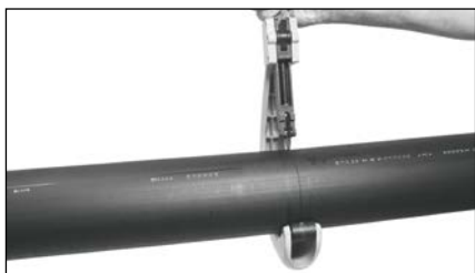
Řez potrubí ruční rotační rezačkou
