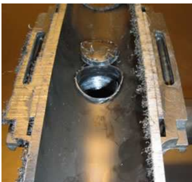
Der er dog en del propper, som falder ud af skæret efter anboring. Desuden efterlader skæret i visse tilfælde en del "skæg".
