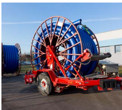
Compact Pipe voda PE 100 RC Hulín – Kroměříž
