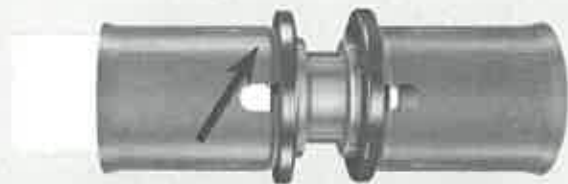
6. ábra: A rozsdamentes acél préshüvelyben található kémlelő nyíláson keresztüli ellenőrizhető a cső ütközésig történő betolása.
