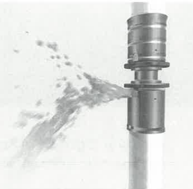
8. ábra: Biztonságot nyújtó rafinált megoldás: a nyomáspróbánál a szivárgási funkció a le nem préselt kötésekkel láthatóvá teszi.
