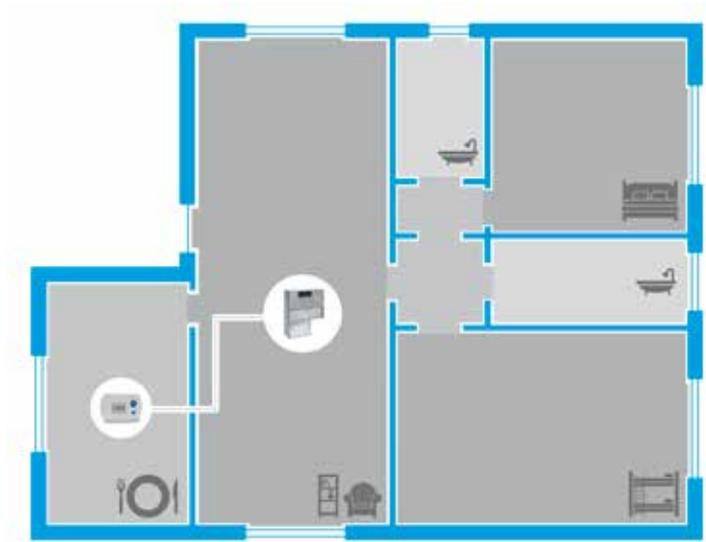
L'igrostato viene utilizzato negli impianti più piccoli e semplici ma che funzionano anche in raffreddamento e non prevedono la regolazione della temperatura di mandata.
