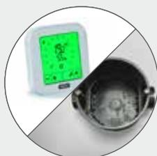
Le sonde ambiente necessitano di una scatola da incasso rotonda da 65 mm dotata di viti (cod. 120300). Installare la scatola a filo intonaco con le viti in posizione orizzontale e fissare la sonda utilizzando dette viti.
