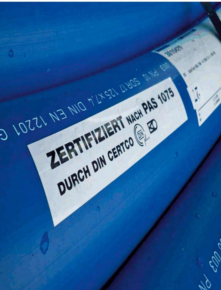
Abb. 11: Wavin PE100-RC Rohre zertifiziert nach PAS 1075 durch den DIN Certco
