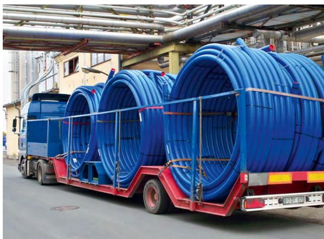
Abb. 4: Wavin PE-Rohre als Ringbunde
