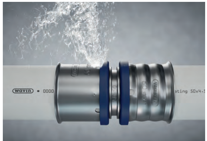
Soll-Leckage-Druckprüfung zeigt mit auslaufendem Wasser den unverpressten Fitting an
