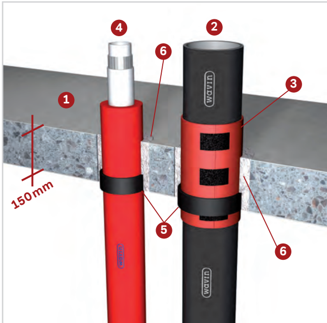
Gerade Rohrführung durch Decke
