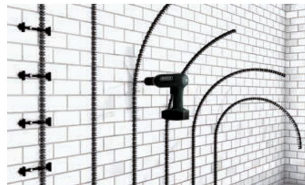
Abb. 5: Montage Rohrklemmschienen (hier vertikal)
