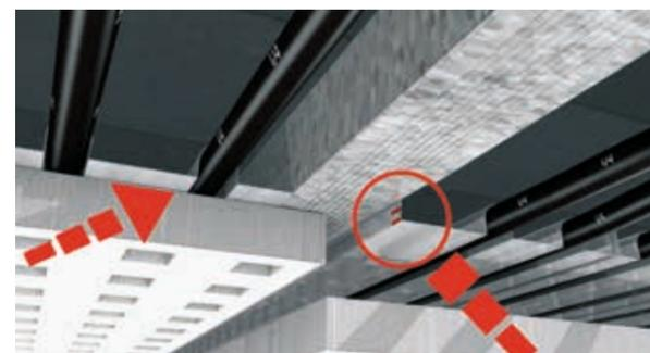
Bei der statischen Auslegung der Unterkonstruktion ist das zusätzliche Gewicht der Wavin Systemmodule zu berücksichtigen. Die entsprechenden Gewichtsangaben entnehmen sie bitte den technischen Daten des gewählten Systems.
