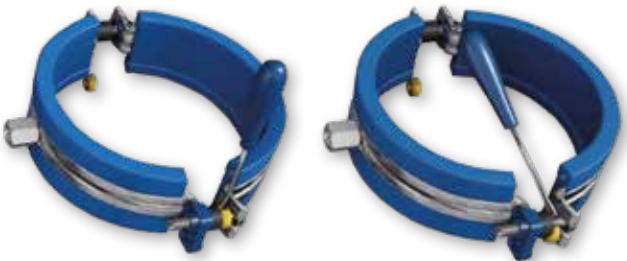
Kiintopistekannakkeesta liukukannakkeeksi: Poista keltainen sovitelevy.
