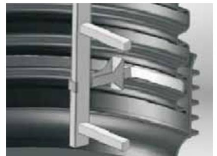
b) Positionnez la bague de fixation (stries en contact avec la paroi de la chambre) avec les supports dans une des rainures intérieures de la rehausse. Bague munie des supports à poser dans la 3<sup>ème</sup> rainure à partir du bas (pour ce qui concerne la fixation la plus basse). Faites attention à ce que l'ouverture de la bague de fixation se trouve bien à l'opposé de la position de l'échelle (à  $\pm 180^\circ$  des supports) (Photo 15).
