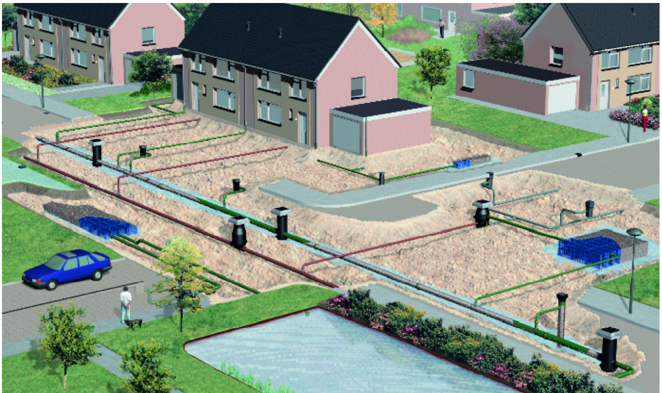
Afb. 20. Huisaansluiting in combinatie met een infiltratiesysteem.
