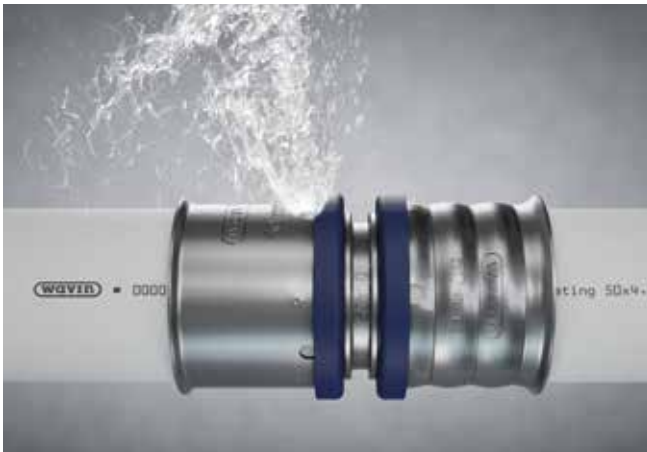
Kuva 16: DLF (Defind Leak Function) paljastaa painetestissä puristamattomien liitäntöjen vuodot.
