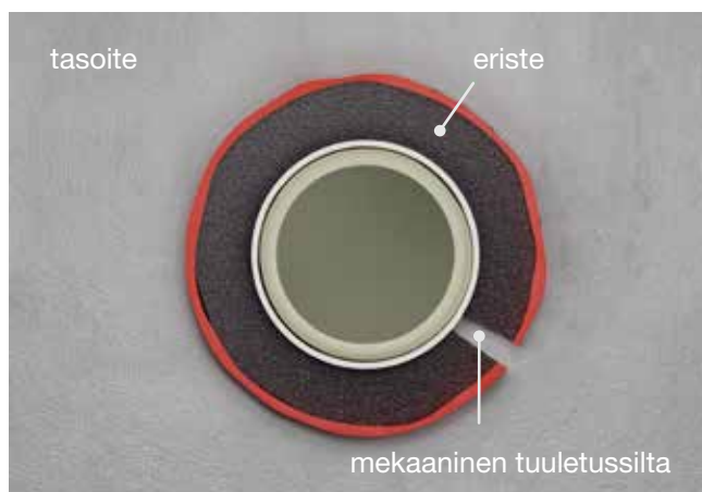
Kuva 41: Mekaaninen tärinänlöpäisy viallisen putkieristyksen kautta.
