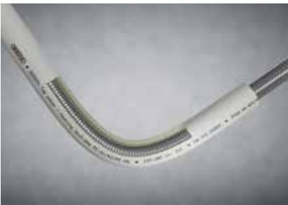
Kuva 27: Putken taivuttaminen taivutusjousella.
