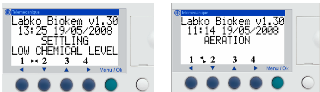
9 pav. Vaizduoklis parodytas, kai generuojamas žemo chemikalo lygio pranešimas [„LOW CHEMICAL LEVEL“] ir aeravimo [„AERATION“] fazės metu.
