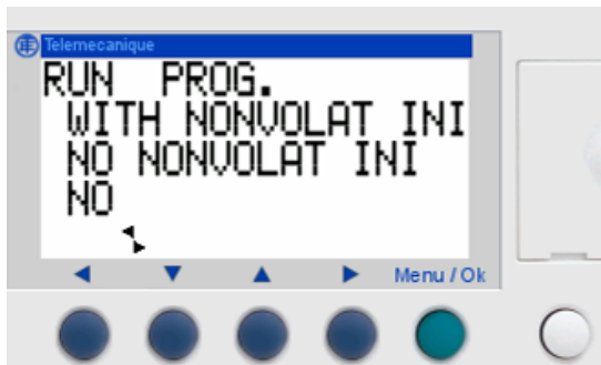
8 pav. „Zelio“ valdymo relės veikimo ir stabdos („RUN/STOP“) meniu.
