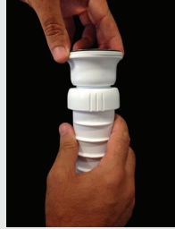
4- Lavabo süzgecini HepvO diyaframının üst rakoru altına saat yönünde çevirerek monte ediniz. Rakoru sıkarak contayı sıkıştırınız. 432'lik HepvO bağlantısı için kit içerisinde yer alan conta ayrıca kullanılmıdır.
