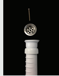
5- Lavabo monte etmek için süzgeç üstü vidasını söküp, metal süzgeç ile plastik taban arasında lavabo kalacak şekilde monte ediniz.
