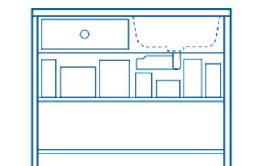
Armoire d'évier avec HepVO installé horizontalement
