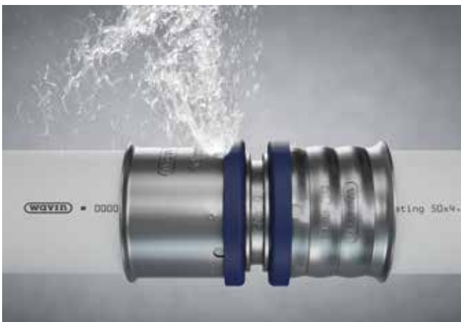
Fig.14: GARANTERAT LÄCKAGE i tryckprovningar visar vilken koppling som inte har pressats genom att denna läcker vatten.
