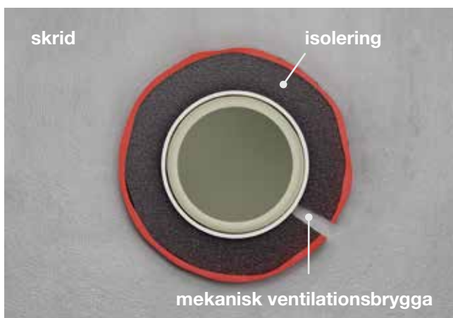
Fig. 33: Mekanisk vibrationsöverföring genom defekt rörisolering.
