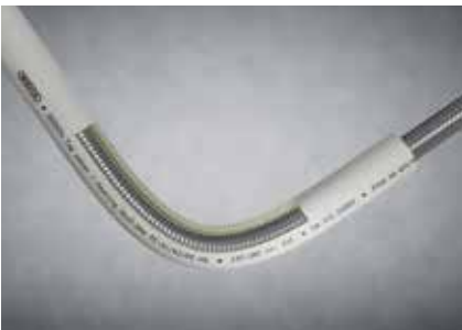
Fig. 22: Bockning av röret med en bockningsfjäder.
