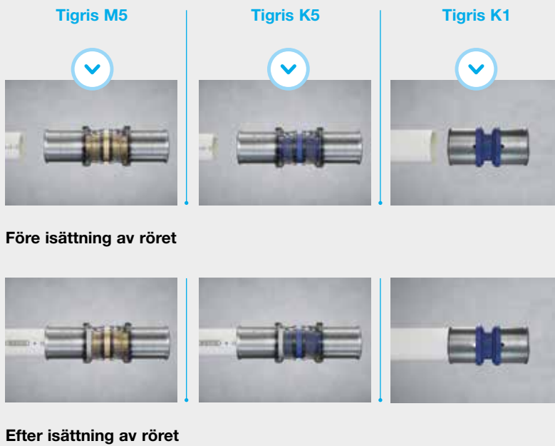
Fig. 19: Kontrollera korrekt rörinsättning med IN4SURE™.
