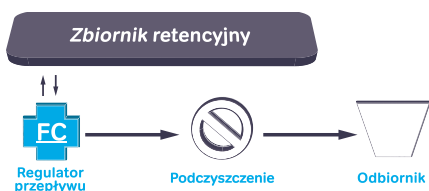
Rys. 20. Ograniczenie przepływu za systemem retencyjnym, włączonym do sieci kanalizacji deszczowej
