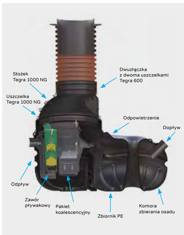
Rys. 43. Budowa separatora Wavin Certo NS.
