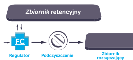
Rys. 21. Ograniczenie przepływu przed systemem podczyszczania i wypływu do zbiornika rozsączającego.
