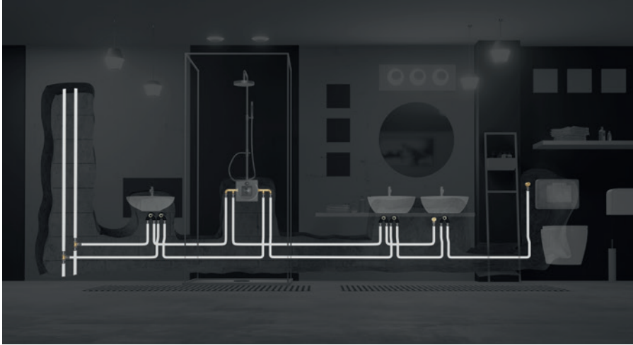
Fig. 43: Installation en série.
