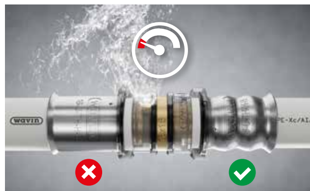
Rys. 7: Funkcja DEFINDED LEAK w trakcie próby ciśnieniowej - wizualne wykrycie nieszczelności przy braku zaprasowania połączenia.
