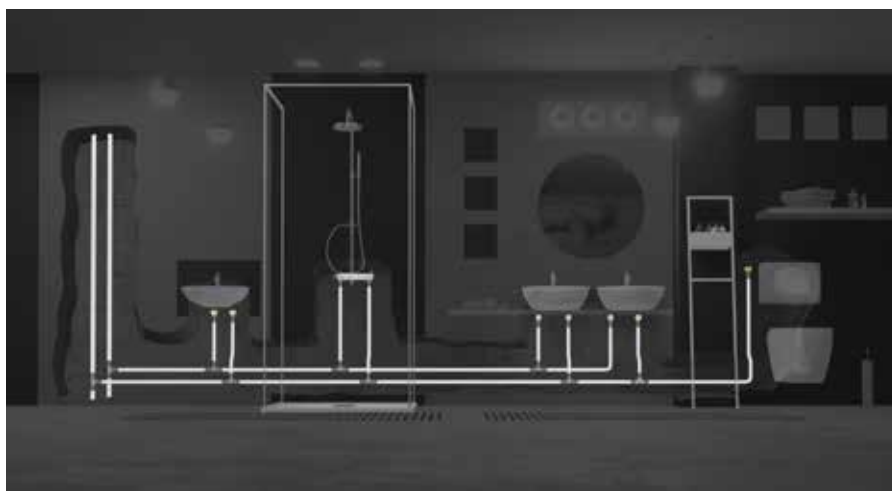
Rys. 41: Instalacja trójnikowa pojedyncza.
