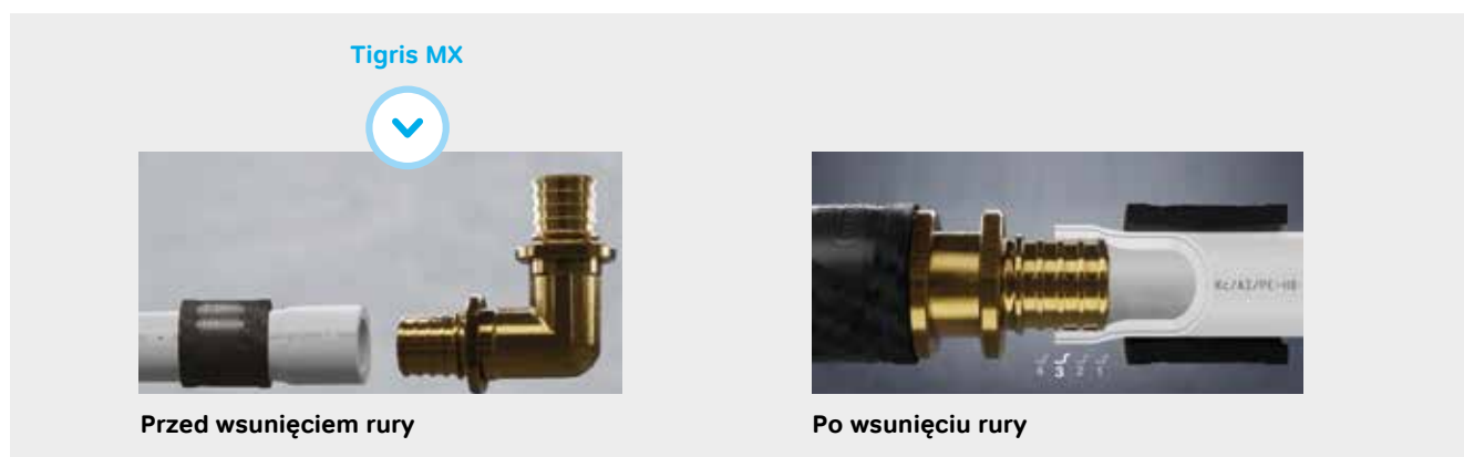
Rys. 26: Kontrola prawidłowego nasunięcia rury.
