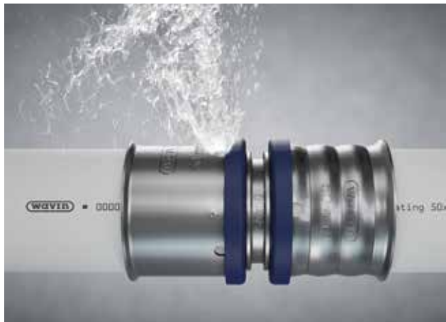
Rys.15: Funkcja DEFINED LEAK w trakcie próby ciśnieniowej: wizualne wykrycie nieszczelności przy braku zaprasowania połączenia.
