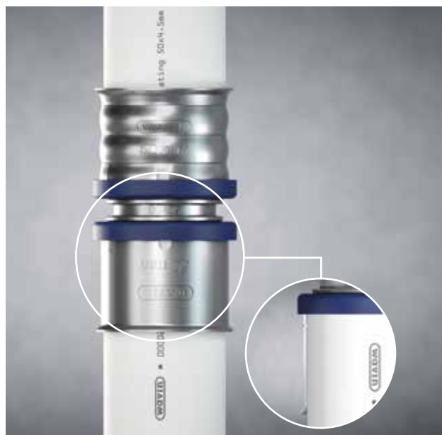
Rys.17: Funkcja PIPEGRIP stabilnie utrzymuje rurę w pozycji umożliwiającej swobodne operowanie zaciskarką.
