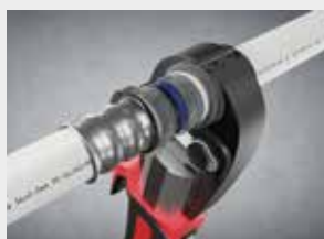
Rys. 21: Położenie szczęk zaciskowych na kształtkach Tigris K5 i Tigris M5.
