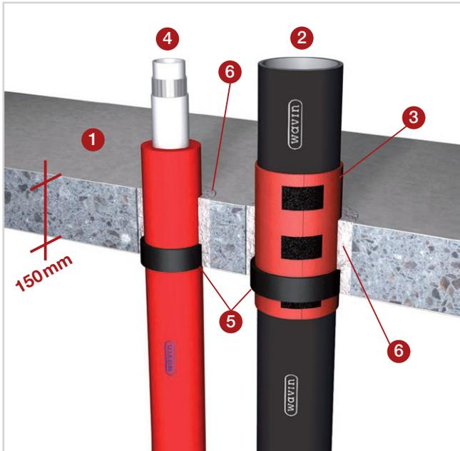
Abb. 55: Gerade Rohrleitung durch Decke
