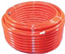
1. Wavin Mehrschicht-Verbundrohr ist im Ringbund mit **9 mm** Dämmung (Wärmeleitfähigkeit = 0,040 W/m·K) lieferbar. Dieses System entspricht der geforderten Dämmung für Rohrleitungen im Fußboden.
