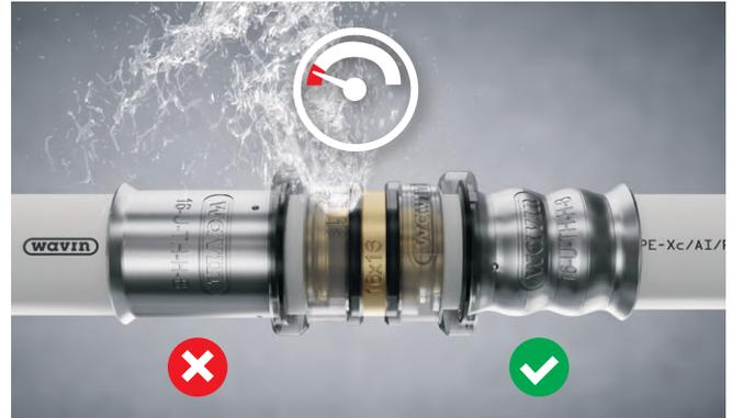
Abb. 13: Soll-Leckage-Druckprüfung zeigt mit auslaufendem Wasser den unverpressten Fitting an
