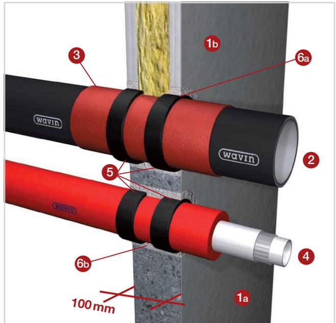
Abb. 56: Gerade Rohrleitung durch Wand
