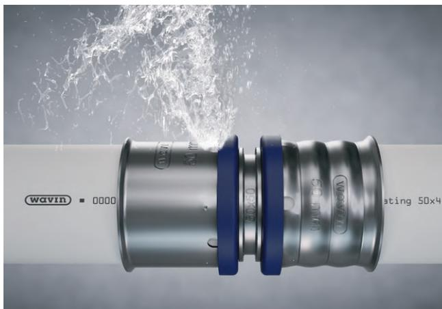
Abb. 17: SOLL-LECKAGE-Druckprüfung zeigt mit auslaufendem Wasser den unverpressten Fitting an
