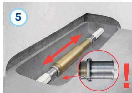
Freies Ende der Reparaturkupplung herausziehen und das andere Verbindungsstück auf das verbleibende freie Rohrende stecken. Im Sichtfenster korrektes Einschieben des Rohrs prüfen.
