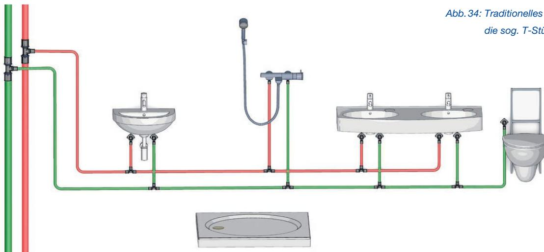
Abb. 34: Traditionelles Verteilsystem, die sog. T-Stück Installation
