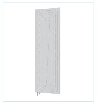
Si possono installare sia in edifici nuovi, sia durante lavori di ristrutturazione. Sono ottenuti dall'abbinamento di una lastra in cartongesso da 15 mm fresata, al cui interno viene posizionata la tubazione da 10 mm, con una lastra di polistirene EPS 200, per aumentarne l'efficienza termica verso gli ambienti interessati.
