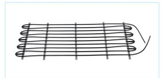
Sistema molto semplice, costituito da pannelli radianti costruiti a partire da un tubo da 10 mm disposto a serpentina, mediante opportune barre di fissaggio e staffe di supporto.
