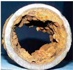
Für Druckrohrleitungen reichen in der Regel mechanische Reinigungen mit Kratzmolchen u. Ä. aus. Wichtig für den Erfolg der Installation ist die Gewährleistung des Mindestquerschnittes. Dafür wird die Rohrleitung nach der Reinigung kalibriert. Die Kamerainspektion, Reinigung und Kalibrierung eines Kanals bzw. einer Altröhrrichtung sind ein Muss für die erfolgreiche Installation.
