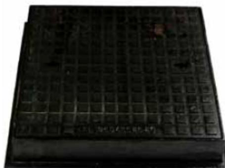
Couvercle et cadre en fonte classe D=400kN. Avec fermeture hydraulique et surface gaufrée, anti-dérapante. Avec encoche de levage centrale, à ouvrir avec clé modèle 4 (option)
