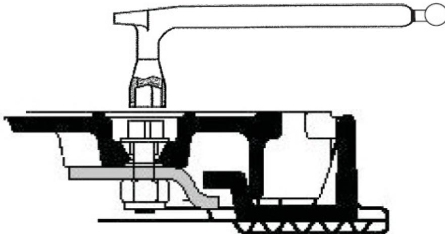
**Description:** Le verrouillage se réalise au moyen d'un écrou pentagonal enfoncé dans le couvercle.
