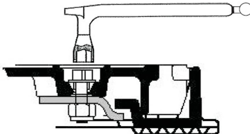
**Omschrijving:** Grendel die wordt aangespannen via een vijfkant bout die verzonken is in het deksel.
