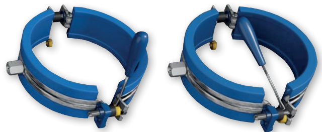
Passaggio da scorrevole a fisso: rimuovere il distanziatore
