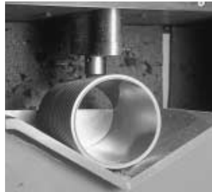
Figur 33 - Produkternes evne til at modstå slag testes dagligt
