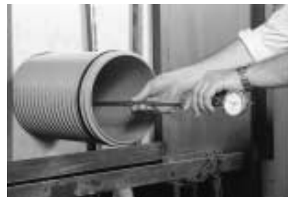
Figur 34 - Gennem box-load test afprøves produkternes fleksibilitet under realistiske forhold
