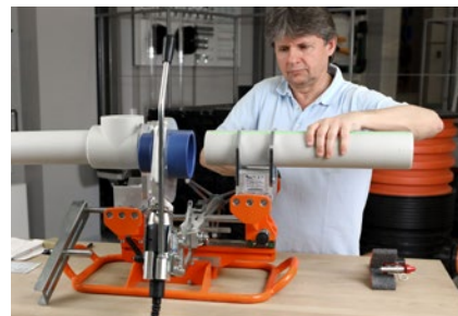
Upnutí do přípravku a vycentrování, poté nahřívání
