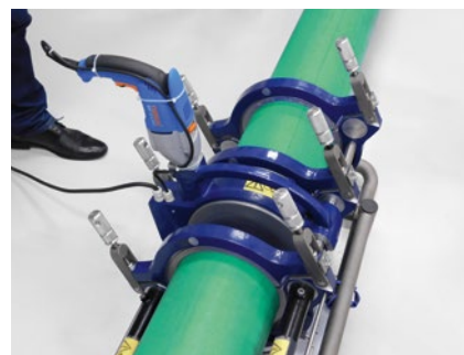
Srovnání konců potrubí hoblíkem
