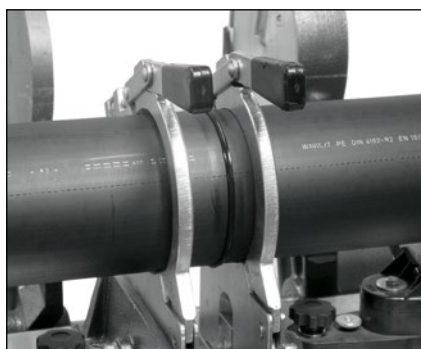
Chladnutí svařeného spoje
