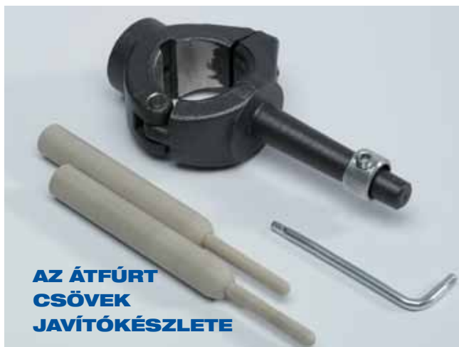
Szárítson és zsírtalanítson. Mérje meg és jelölje a beillesztési mélységet a tűskén, a megfúrt cső falvastagságától függően + 2 mm-re állítsa be a távtartó gyűrűt a hegesztőfej tűskéjén.
