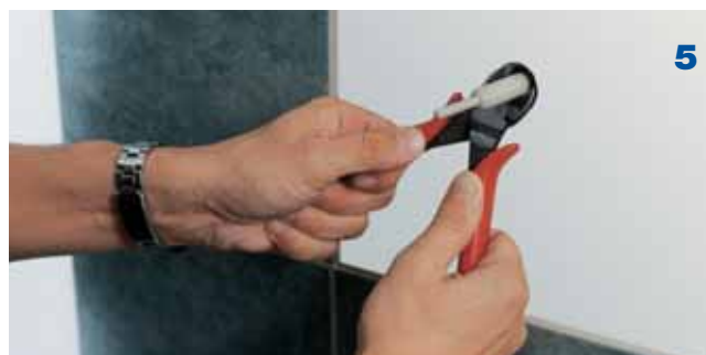
Amikor kihűlt, vágja le a javító tűske maradék részét egy vágószerszámmal.
