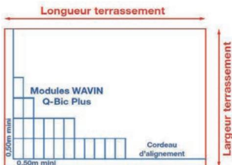
Un espace minimum de 0,50m est nécessaire entre les parois de la structure et le  **pied de talus**  afin de permettre un accès sécurisé conformément à la réglementation et assurer les opérations de :
