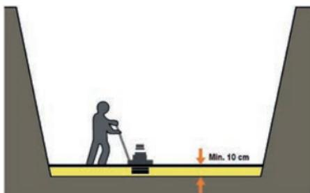
Les grosses pierres et les lentilles d'argile, qui peuvent être la cause de points de pression excessifs, seront retirées du fond de fouille.
