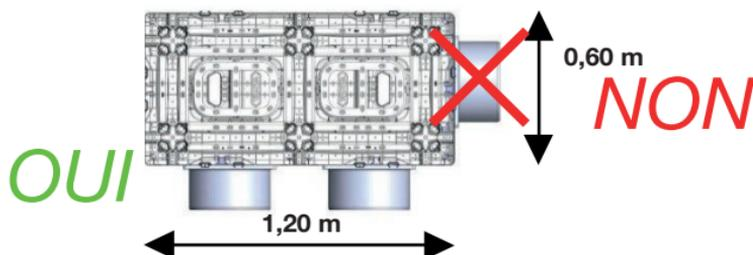
Selon les contraintes de connexion au réseau et le diamètre des connexions il peut être nécessaire de tourner les modules de  $90^\circ$  sur toute une hauteur.
