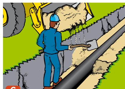
6 Sidefylling skal skje lagvis.
