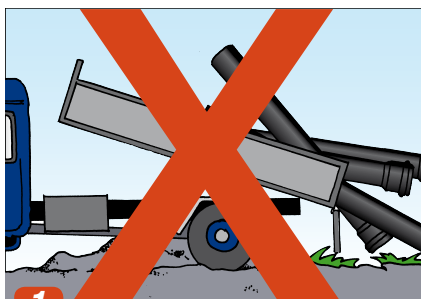
1 Rør må ikke tippes av eller trekkes over kanten på lasteplan.
