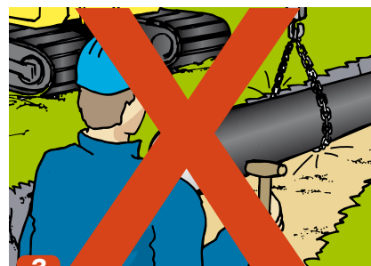
3 Unngå direkte kontakt mellom rør, kroker, kjeder eller metallwirer.
