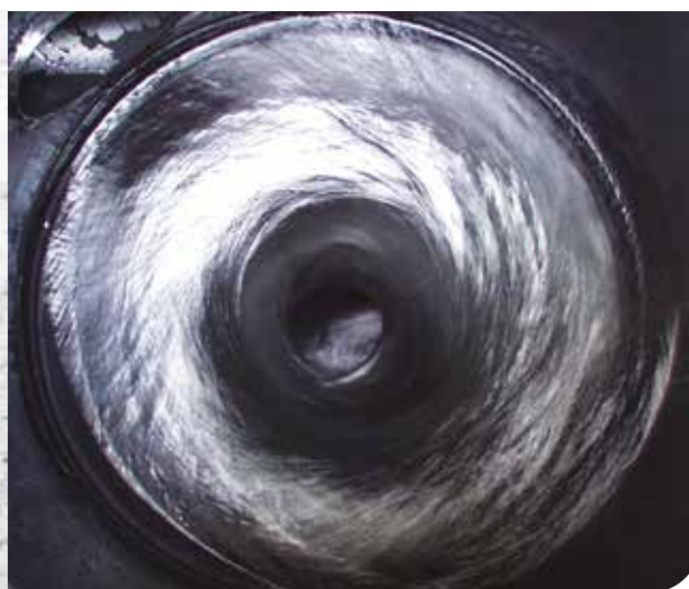
Charakter przepływu w studzience do wytracania energii
