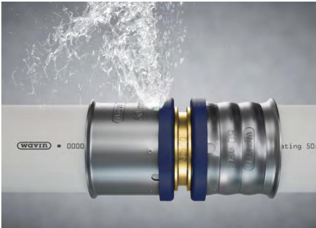
Figure 13 : Fonctionnalité DEFINED LEAK révélant un raccord non serti pendant l'essai de pression.
