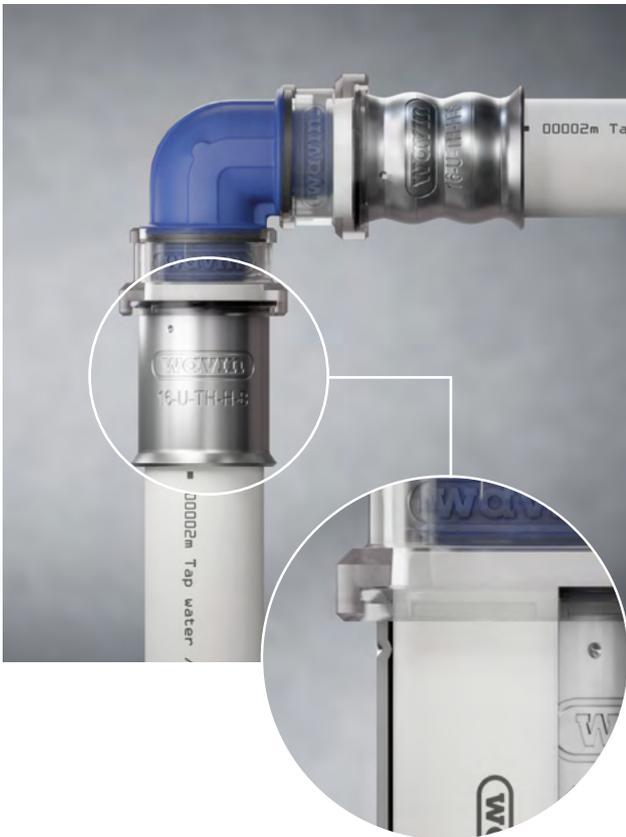
Figure 11 : La fonctionnalité PIPEGRIP maintient fermement le tube en position et permet d'avoir les mains libres pour utiliser la sertisseuse.
