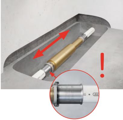
5. Tirez l'extrémité libre du manchon de réparation et insérez l'autre raccord sur l'extrémité libre restante du tube.
