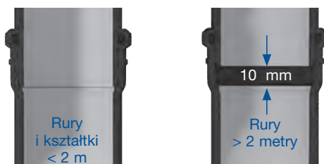
Rys. 55. 10 mm przerwy dla wydłużeń termicznych.
