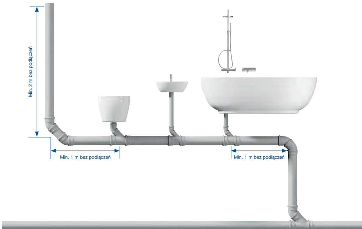
Rys. 24. Przesunięcie pionu większe niż 2 m z odcinkami rur wolnymi od połączeń – przykład.
