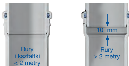
Rys. 34. 10 mm przerwy dla kompensacji termicznej.
