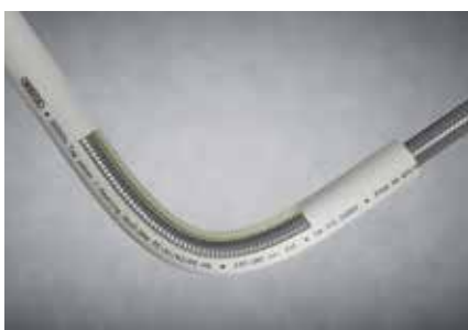
Fig. 27: Bukning af røret med en bukkefjeder.
